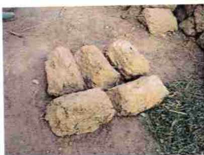
Aspect de l'adobe après séchage
