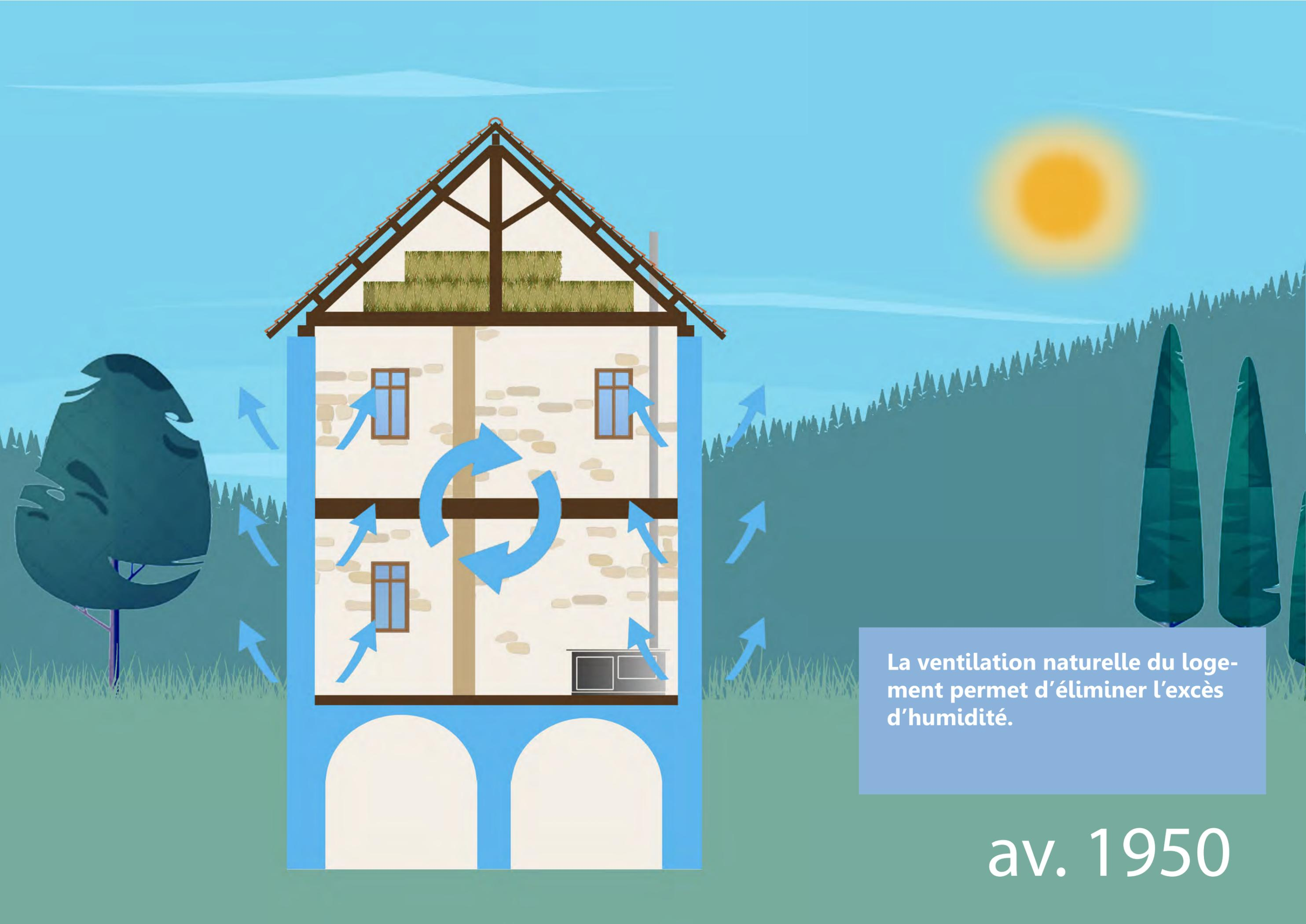
La ventilation naturelle du logement permet d'éliminer l'excès d'humidité.
